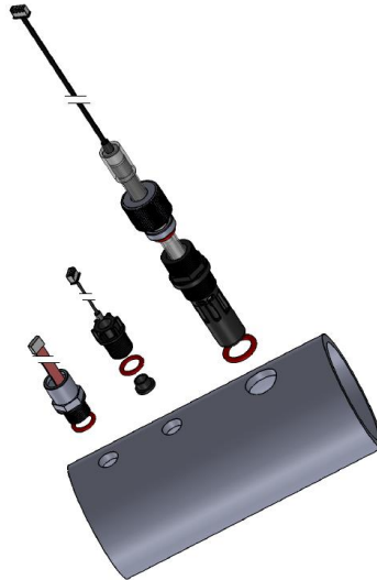
Afbeelding 46 - Sensors on Threaded 3" Pipe
