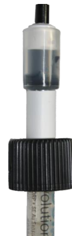
Afbeelding 50 - Aansluiting van de sonde SO4913
